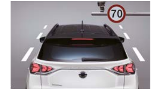
Sistema de reconocimiento de señales de tráfico (TSR) Detecta las señales de tráfico cercanas, aplica un software de reconocimiento para leerlas y muestra un icono de información en la pantalla.
