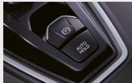
Freno electrónico de estacionamiento (EPB) equipado con la función Auto-Hold (freno automático en parada)
