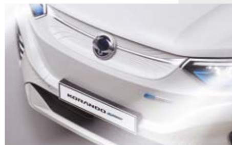
Rejilla de ventilación
