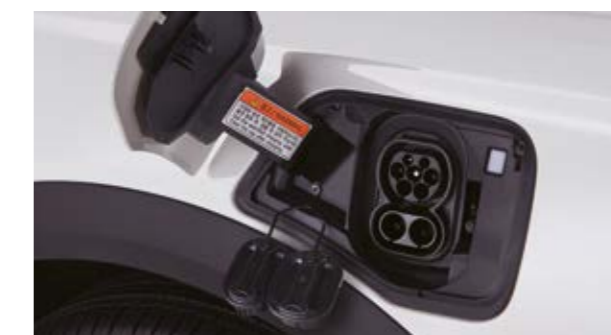
Conector de carga tipo 2 (Mennekes) para carga en corriente alterna (carga normal) y conector CCS para carga en corriente continua (carga rápida)
