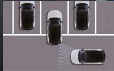
Alerta de tráfico trasero (RCTA) Cuando el conductor está dando marcha atrás, el RCTA frena automáticamente para evitar una colisión inminente si el sistema ha detectado tráfico trasero cruzado.
