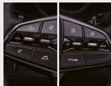
Interruptores de control remoto y sistema de control de crucero en el volante
