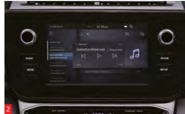
1 Cuadro de instrumentos digital TFT de 26,03 cm (10,2") 2 Sistema de infoentretenimiento con pantalla de 20,32 cm (8") 3 Sistemas Apple CarPlay® / Android Auto™
